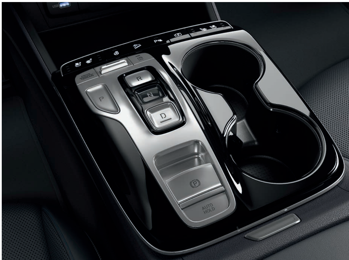
Elektronické ovládání převodovky tlačítky „Shift by Wire“.
